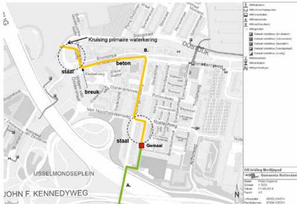
Figuur 3.8 Locatie leidingbreuk en materialen persleiding
