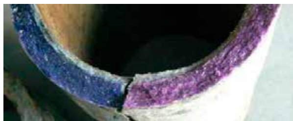
Figuur 5.8 Onderzoek kwaliteit AC-buis. Links: thymolftaleïne-test. Rechts: fenolftaleïne-test. Uit: Mesman, G. 2014. Memo uitlogingstest fenolftaleïne vs thymolftaleïne.
